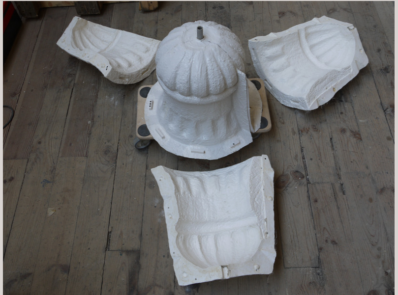
2. La chape en plâtre démontée
