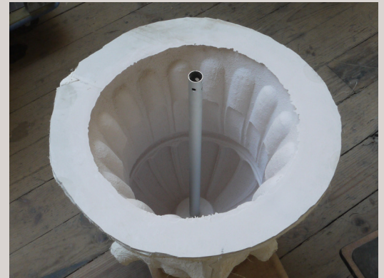
2. Mise en place d'un tube central
