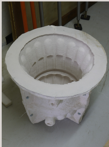
1. Intérieur du moule en silicone et chape de plâtre
