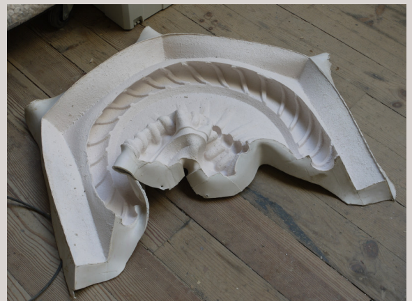
6. La peau en silicone déposée pour nettoyage
