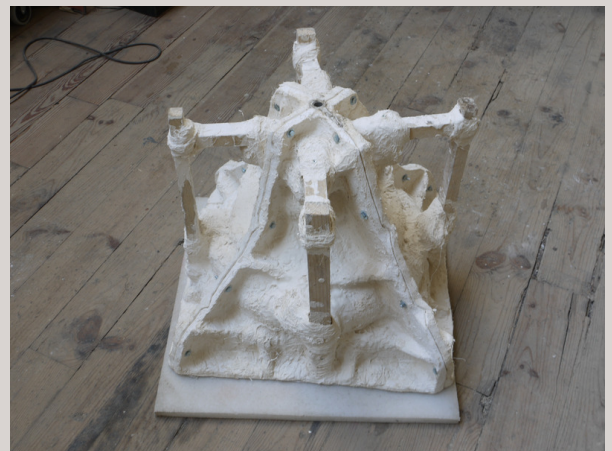
4. Le moule du piédoche est retourné pour être démonté
