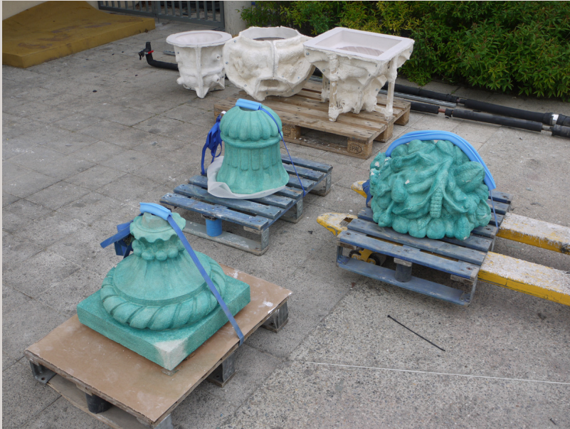
Moules et éléments originaux recouverts d'agent démoulant
