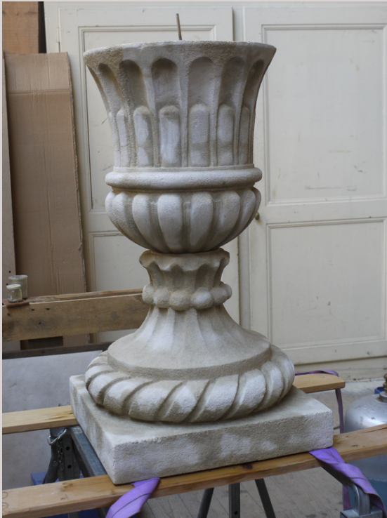
1. Après élimination de l'agent démoulant, un nouveau badigeon est appliqué sur le vase
