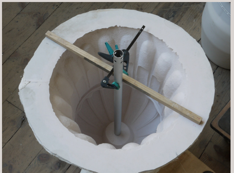
3. Le tube central maintenu par une baguette en bois et un serre-joints
