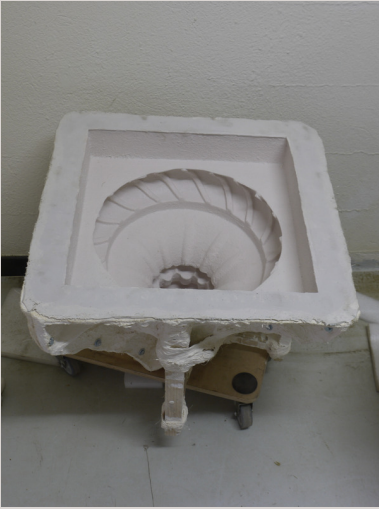
1. Intérieur du moule en silicone et chape de plâtre
