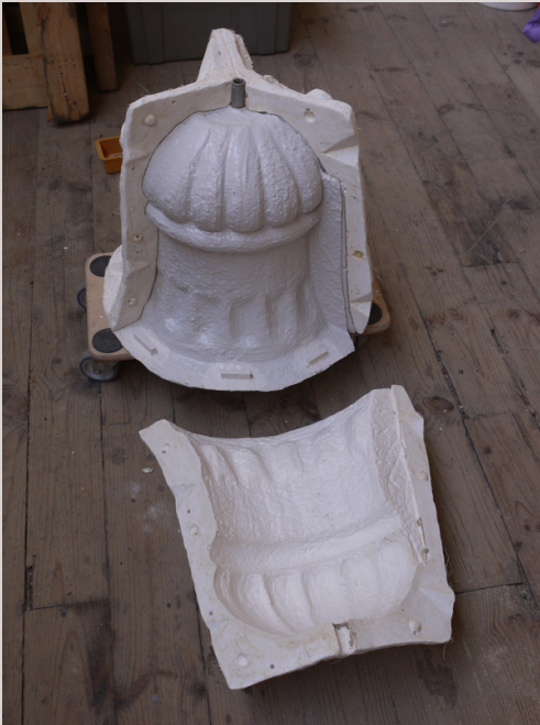
1. Début du démontage de la chape en plâtre
